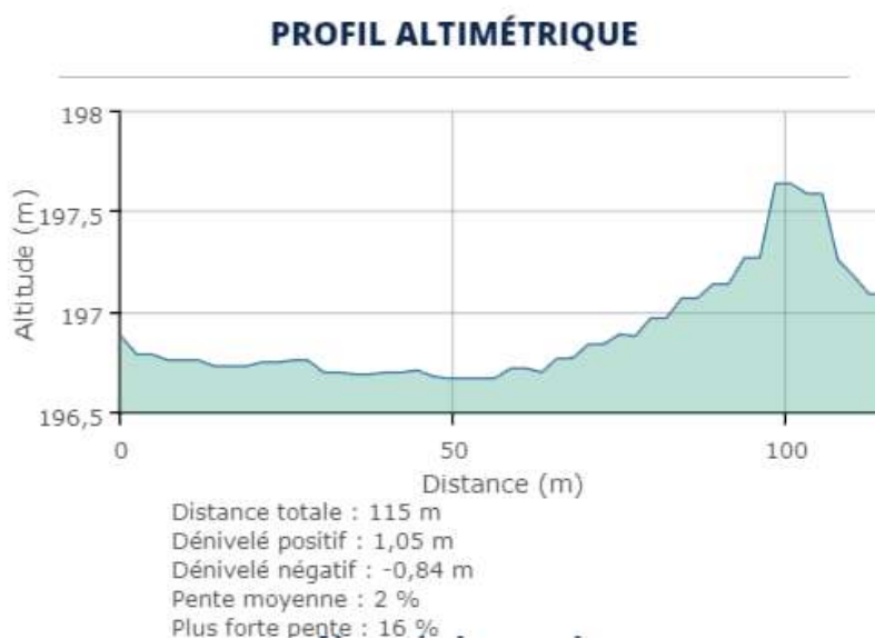
Figure 3 : Profil altimétrique du site selon l'axe A-A'
